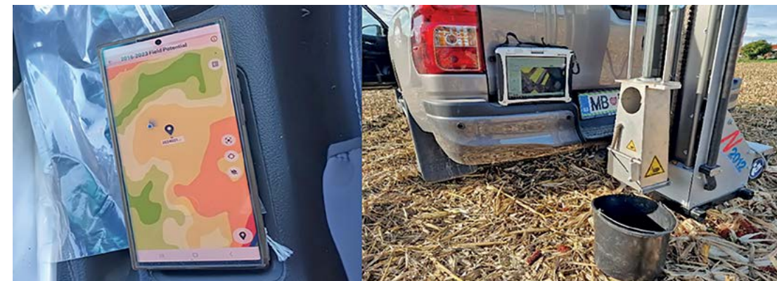
Slika 12: Uporaba aplikacije za najdbo točke za odvzem talnega vzorca in avtomatski vzorčevalnik
