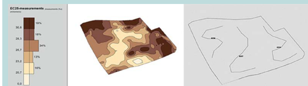
Slika 10: Karta elektroprevodnosti tal in lokacije odvzema talnih vzorcev
